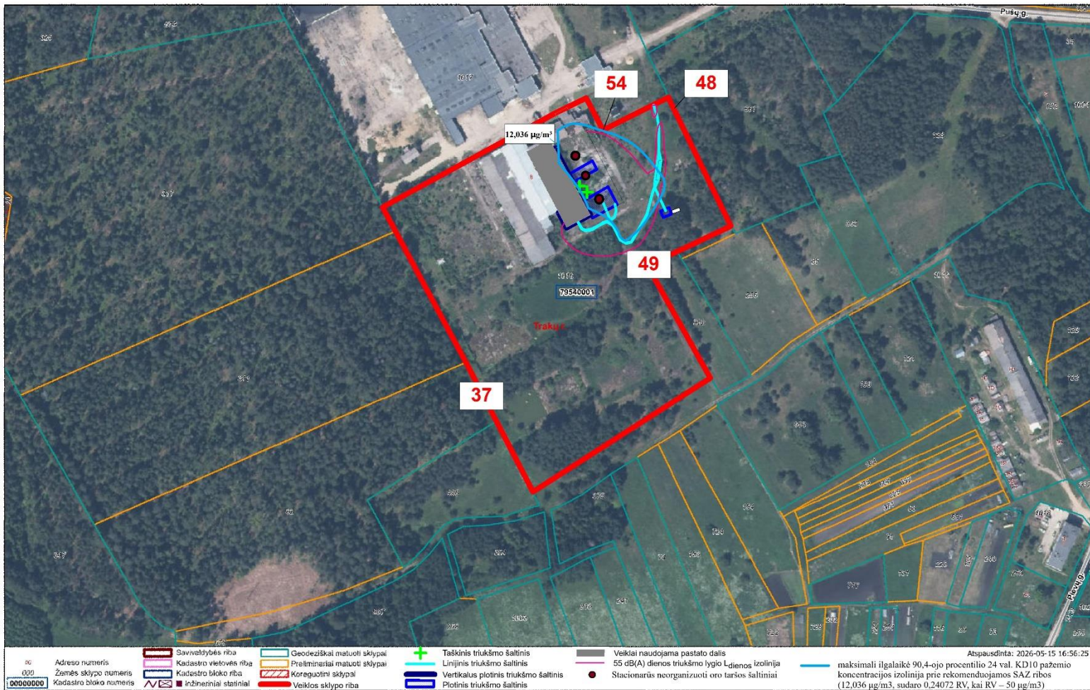
17 pav. Rekomenduojama sanitarinė apsaugos zona su viršnormine 55 dB(A) triukšmo lygio izolinija dienos metu ir maksimalia 90,4-ojo procentilio ilgalaikė 24 val. kietųjų dalelių KD 10 pažemio koncentracijos izolinija (12,036 µg/m 3 , sudaro 0,24072 RV, kai RV – 50 µg/m 3 ) prie nustatomos SAZ ribos. Naudota Lietuvos koordinatių sistema LKS-94. Mastelis 1:2000.
